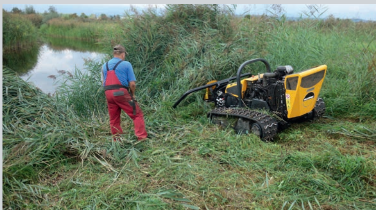
Schilfmähen mit einem Roboter. Bild: P.-A. Sydler.
